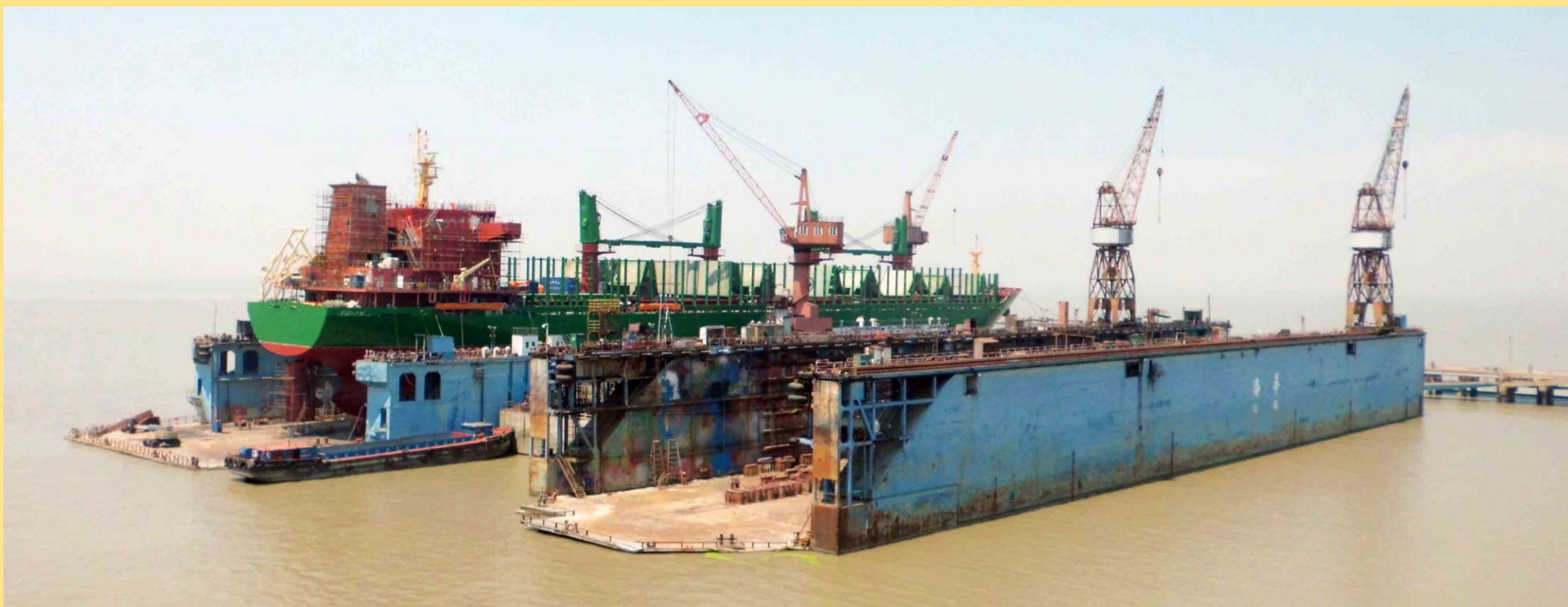
Diques flotantes para varadas finales
